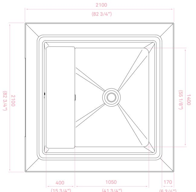
Vasca con bordo sfioratore realizzata in vetroresina/gelcoat speciale, anti osmosi. Telaio di supporto in acciaio zincato poggiato su 8 piedini regolabili. Zoccolo estetico con funzione di vasca di sicurezza. Riscaldamento dell'acqua a scelta con scambiatore di calore acqua-acqua oppure elettrico.
