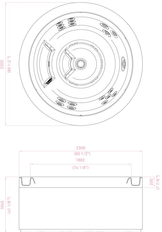
Becken aus Metacryl mit Überlaufrand bestehend aus einer einteiligen, glasfaserverstärkten Schale, Halterrahmen aus Edelstahl aufliegend auf verstellbaren Füßen und Überlaufbecken-Verkleidung aus einem Glasfaser/Gelcoat – Paneel.
