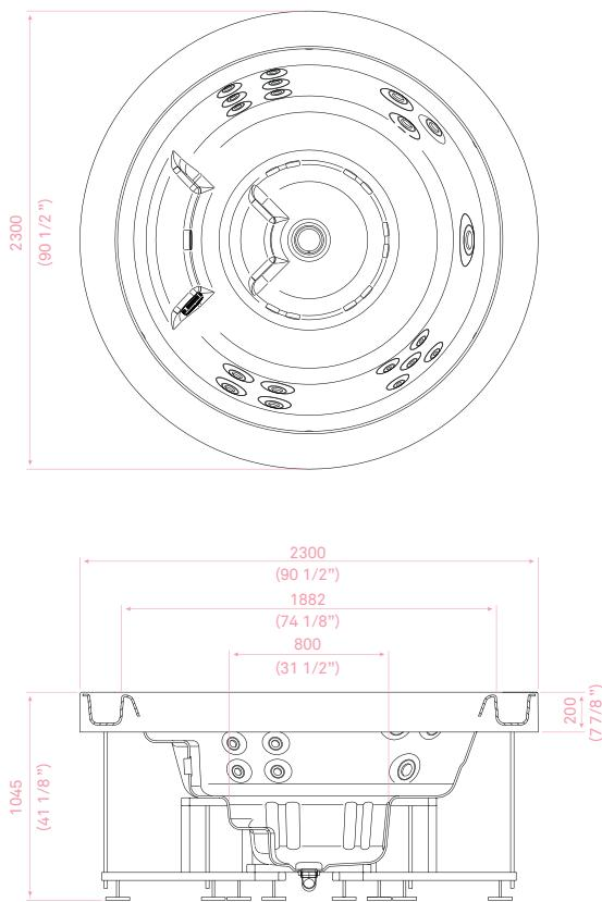
Becken aus Metacryl mit Überlaufrand bestehend aus einer einteiligen, glasfaserverstärkten Schale, Halterrahmen aus Edelstahl aufliegend auf verstellbaren Füßen und Überlaufbecken-Verkleidung aus einem Glasfaser/Gelcoat – Paneel.
