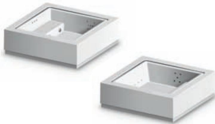
Vasca con bordo sfioratore realizzata in vetroresina/gelcoat speciale, anti osmosi. Telaio di supporto in acciaio zincato poggiato su 8 piedini regolabili. Zoccolo estetico con funzione di vasca di sicurezza. Ugelli in acciaio inox. Riscaldamento dell'acqua a scelta con scambiatore di calore acqua-acqua oppure elettrico.
