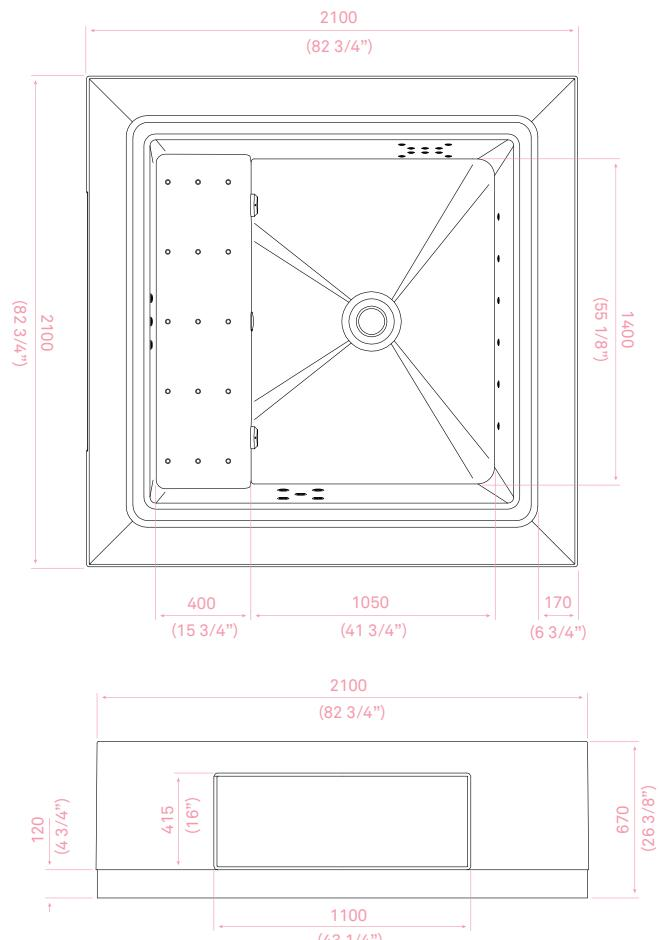
Überlaufbecken hergestellt mit einem speziellen Glasfaser/Gelcoat gegen Osmose. Trägerrahmen aus verzinktem Stahl auf 8 verstellbare Füße gestellt. Ästhetischer Sockel mit Funktion von Sicherheitsbecken. Düsen aus Edelstahl. Wasserheizung nach Wahl mit Wasser-Wasser Wärmetauscher oder Elektroheizung.
