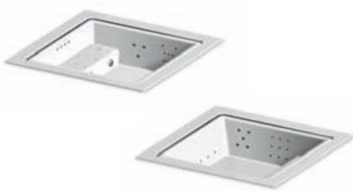
Vasca con bordo sfioratore realizzata in vetroresina/gelcoat speciale, anti osmosi. Telaio di supporto in acciaio zincato poggiato su 8 piedini regolabili. Ugelli in acciaio inox. Riscaldamento dell'acqua a scelta con scambiatore di calore acqua-acqua oppure elettrico.
