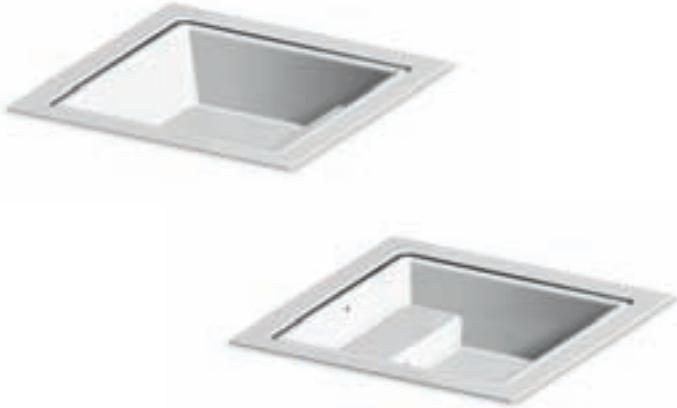
Vasca con bordo sfiatore realizzata in vetroresina/gelcoat speciale, anti osmosi. Telaio di supporto in acciaio zincato poggiato su 8 piedini regolabili. Riscaldamento dell'acqua a scelta con scambiatore di calore acqua-acqua oppure elettrico.
