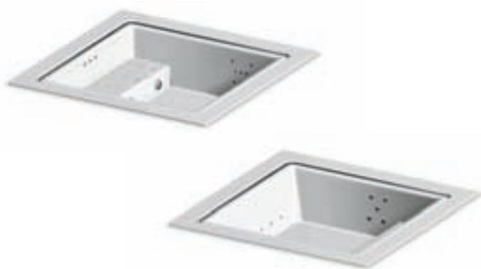
Vasca con bordo sfioratore realizzata in vetroresina/gelcoat speciale, anti osmosi. Telaio di supporto in acciaio zincato poggiato su 8 piedini regolabili. Ugelli in acciaio inox.
